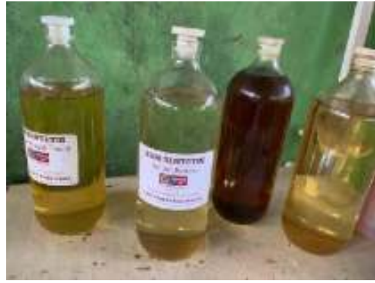
Gambar 4.4 Fast Pyrolysis untuk Penanganan Sampah Plastik menjadi Bahan Bakar Minyak dari Kabupaten Banjarnegara
