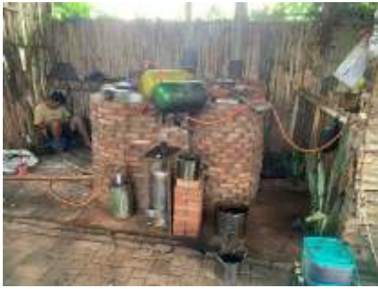
Gambar 4.4 Fast Pyrolysis untuk Penanganan Sampah Plastik menjadi Bahan Bakar Minyak dari Kabupaten Banjarnegara
